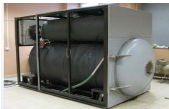
Рис. 3. Сублимационная сушильная камера лаборатории Российского государственного архива научно-технической документации 41
